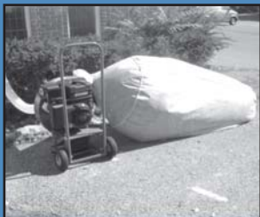
Système d'aspiration pour le retrait de l'isolant.
